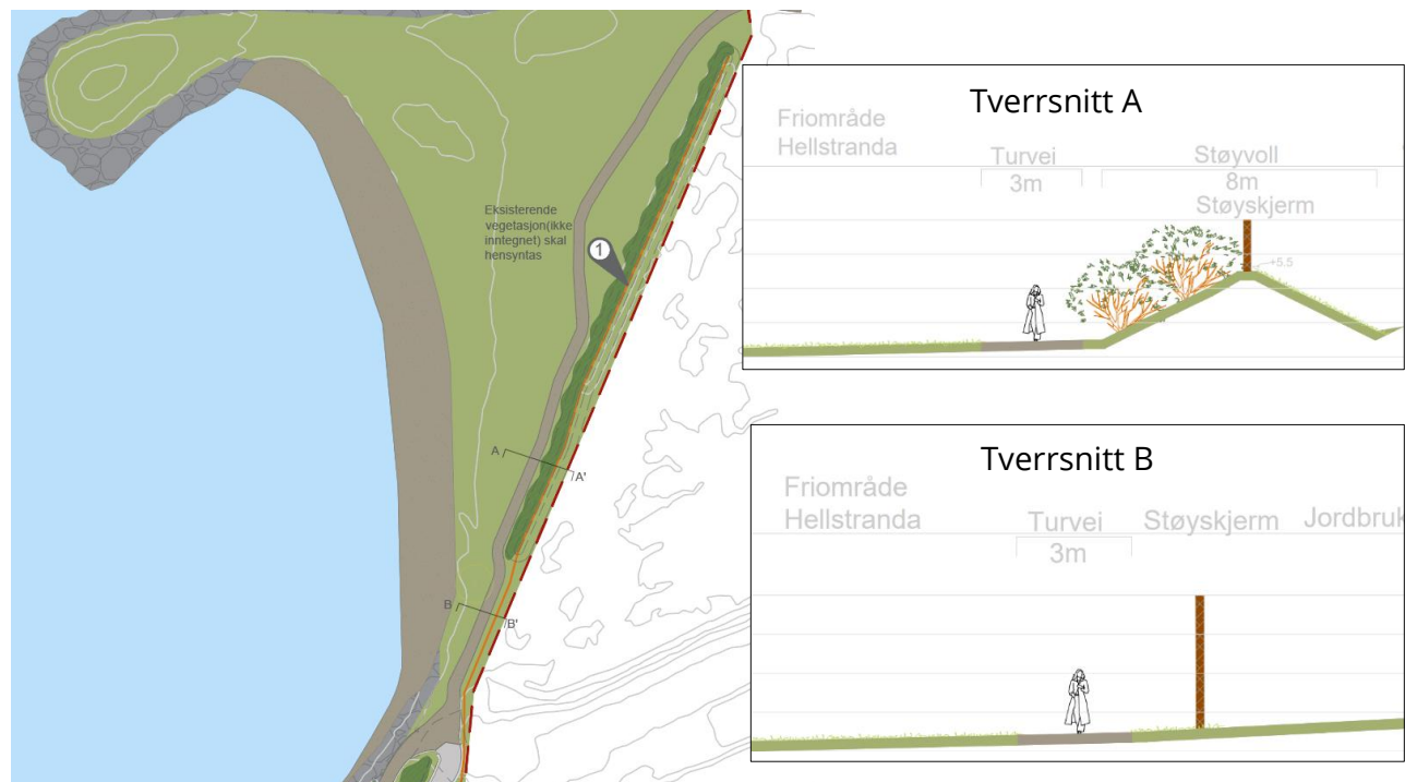
Figur 13: Illustrasjon av støyvoll/skjerms prinsipp langs Hellstranda friområde, både i snitt A og B.
