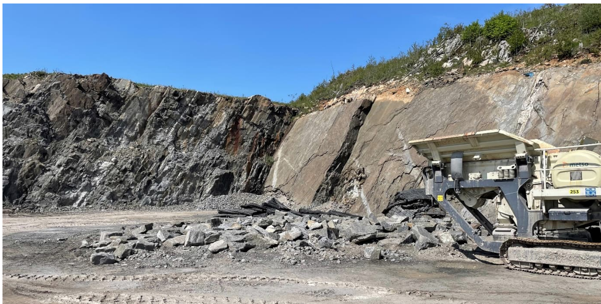
Figur 9-6: Dagbrudd ved Fikkjebakke som viser markert benkning langs foliasjonen. Bildet er tatt ved ca. profil 2650 mot nordvest. Fotograf: Ingvild Sangesland Qvist.
