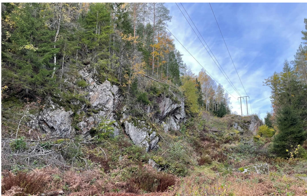
Figur 10-8: Bergblotning som viser tydelig foliasjon ved ca. profil 700, sidevei til Sannidal (VIPS-nr. 21198). Bildet er tatt mot nordvest. Fotograf: Ingvild Sangesland Qvist.
