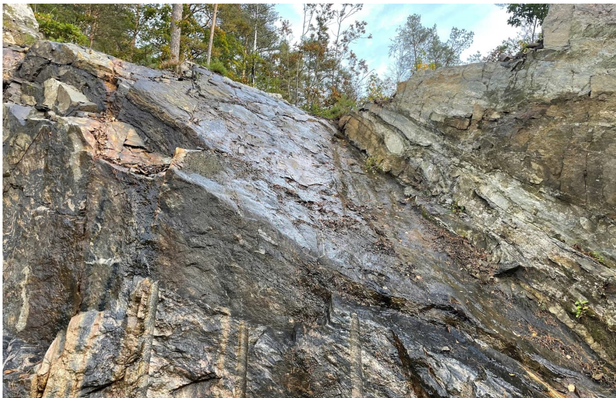
Figur 19-4: Foliasjonsplan med 5 cm tykt biotittlag (svakhetssone A). Registrert ved ca. profil 17400. Sett mot nordøst. Fotograf: Ingvild Sangesland Qvist.
